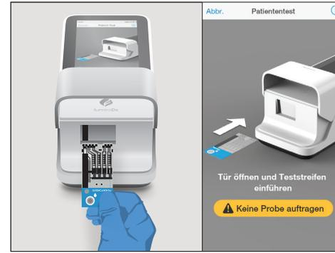
3. Nach der entsprechenden Aufforderung die Tür des Instruments öffnen und den Teststreifen vorsichtig bis zum Anschlag einführen. Die dicke schwarze Orientierungslinie auf dem Teststreifen muss dabei links liegen und mit der schwarzen Linie am Instrument fluchten. Die Probe nicht vor Aufforderung auftragen. Wenn eine neue Teststreifen-Charge zum ersten Mal verwendet wird, die Chargen-Kalibrationsdatei installieren. Weitere Einzelheiten bitte dem Plattform-Benutzerhandbuch entnehmen.
